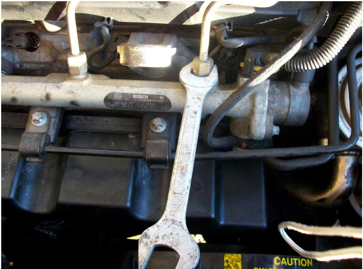
On prend une clé plate de 14 et on enlève la durite de sortie de gasoil en desserrant les deux écrous qui viennent eux aussi assez facilement.
