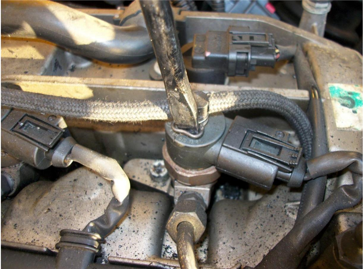
Dans un premier temps à l'aide d'un tournevis on déclipse l'arrivée de gazoil en tirant sur le petit clip qui se défait facilement, on le pose en évidence pour ne pas le perdre.
