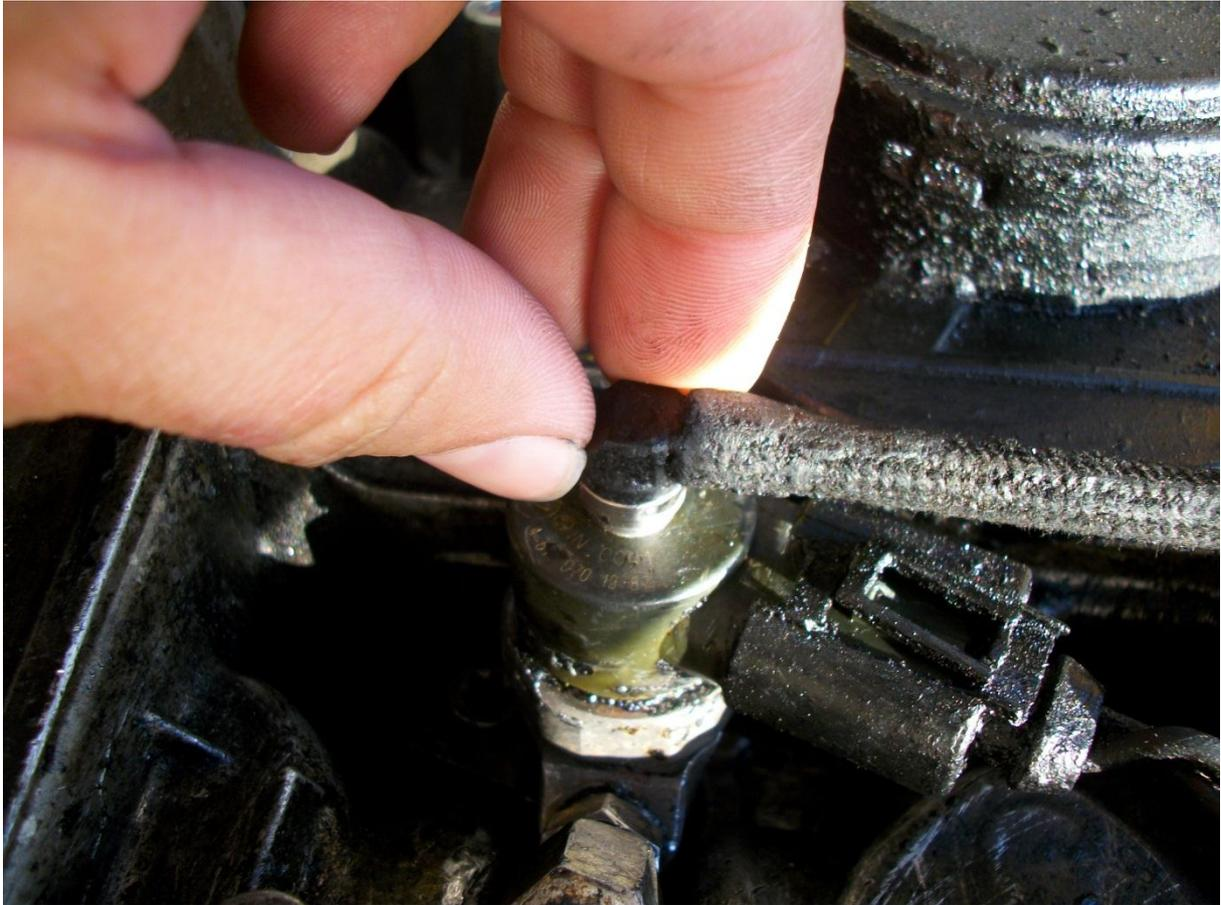
On tire ensuite vers le haut pour décrocher le tuyau d'arrivée de gasoil qui vient lui aussi facilement.
