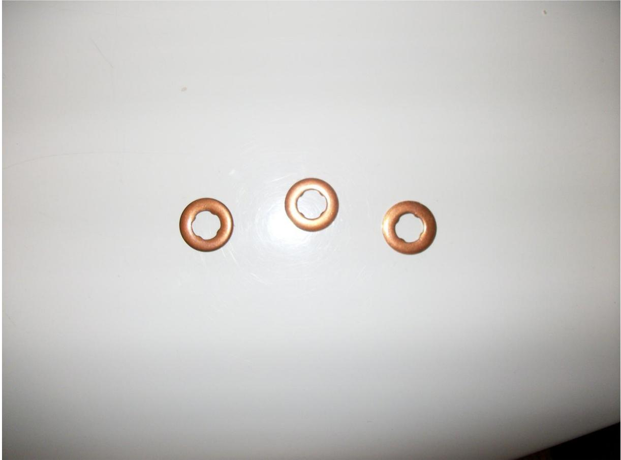
Les joints tout neufs à enfiler sur chaque injecteur et remontage dans l'autre sens en faisant attention de ne pas serrer trop fort la vis de bride d'injecteur.
