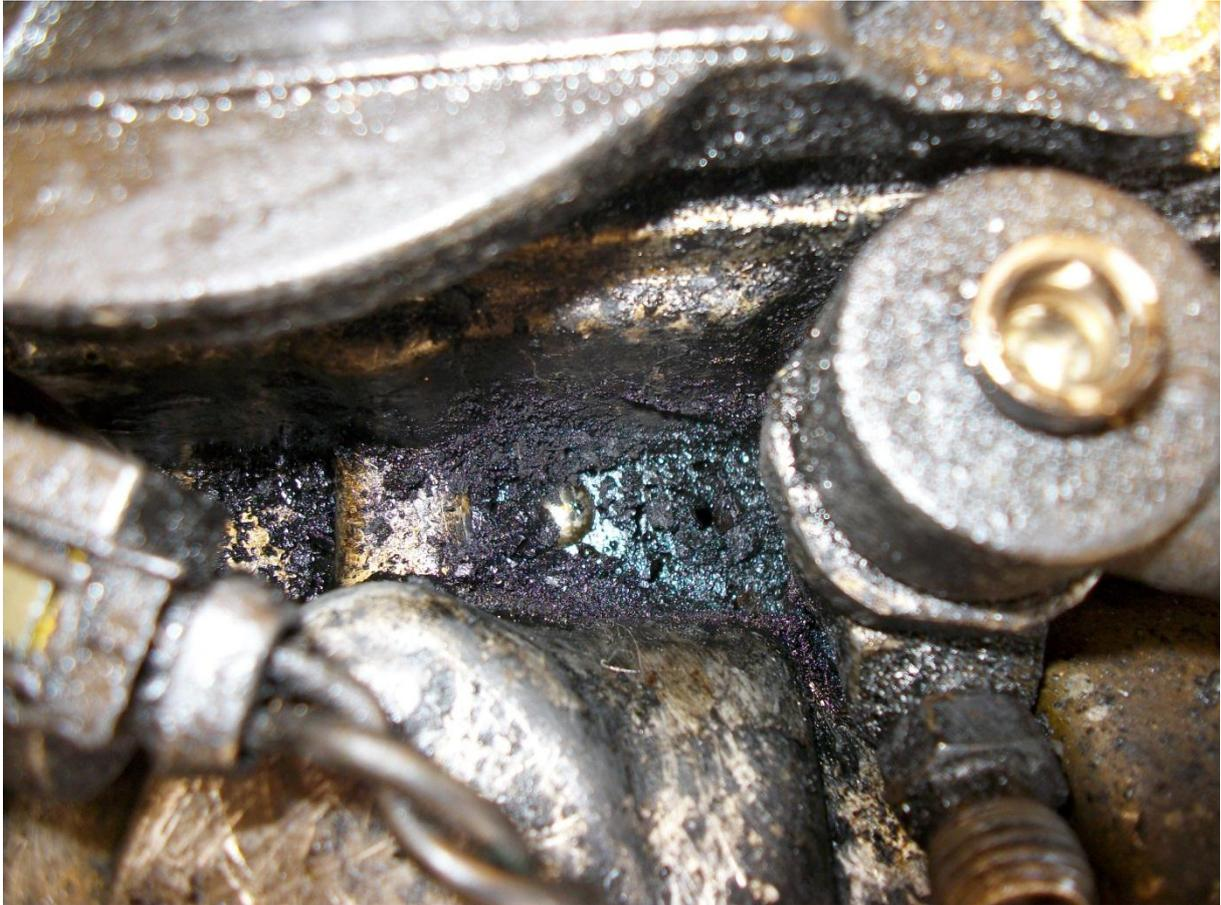
Alors là nettoyage impératif en grattant avec un tournevis dans une main et l'aspirateur dans l'autre pour ne pas en faire tomber dans le trou de vis de bride.
