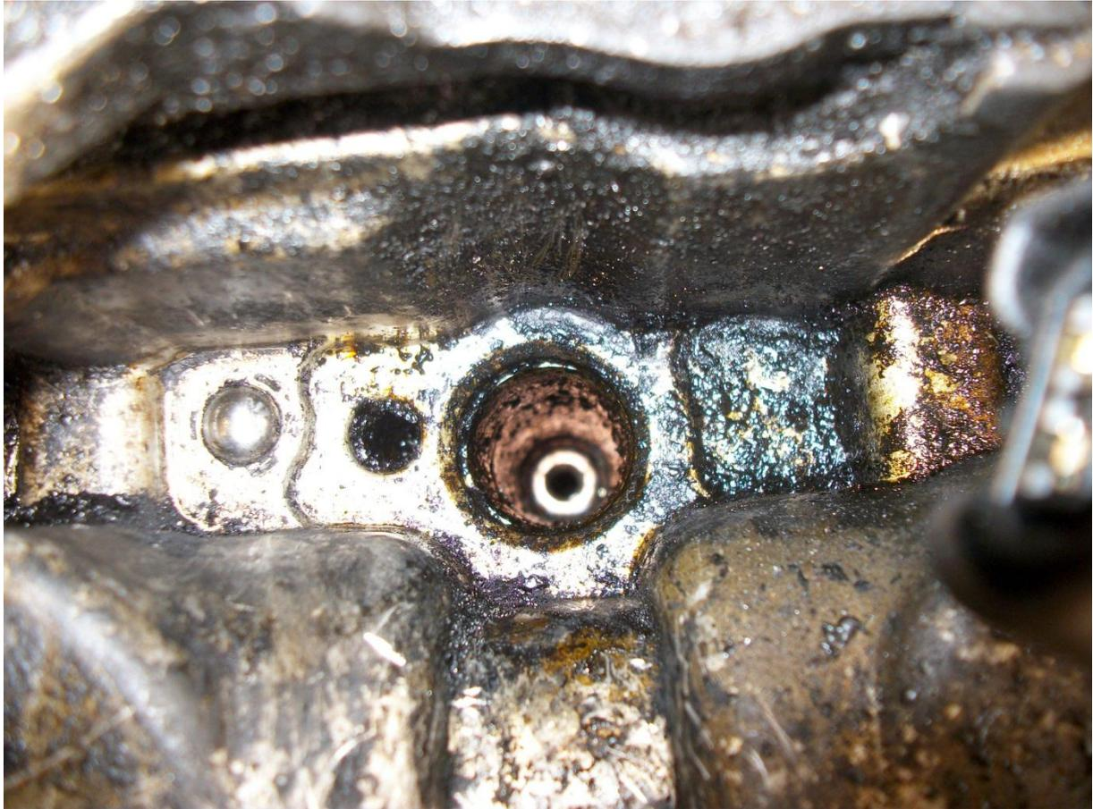
Bon et bien il y a encore du nettoyage à faire ..... On voit le joint en cuivre dans le fond du puit.
